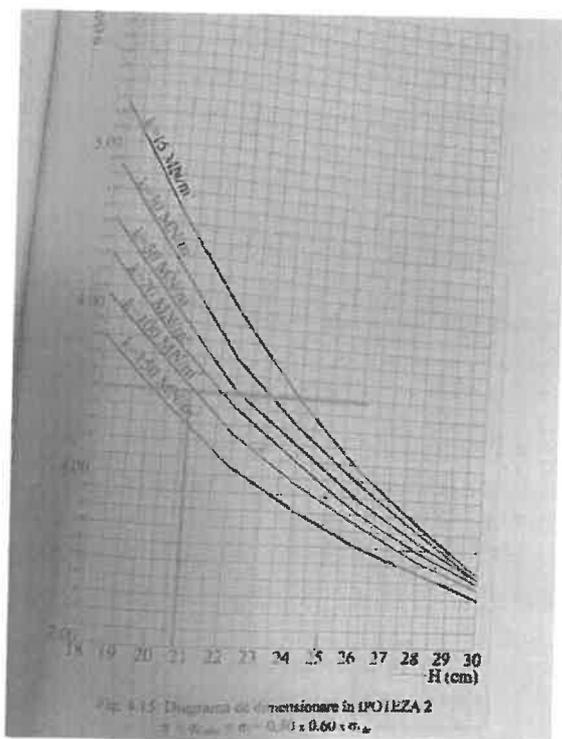
Grosimea dalei din beton de ciment,  $H$  se determină din diagrama de
